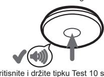
Pritisnite i držite tipku **Test** 10 sekundi. Alarm će se oglasiti zvučnim signalom normalne glasnoće alarmu od 85 dB.
