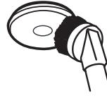
3c Da biste sprječili mogućnost onečišćenja senzora u vašem alarmu, ne nanosite boju na alarm, nemojte koristiti sredstva za čišćenje, aerosolne sprejeve ili otapala
