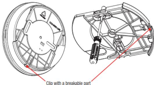
Alarm mora biti fiksiran horizontalno i na strop pomoću montažne ploče. Montažna ploča se može pričvrstiti na strop pomoću središnje rupe ili dva utora u (vidi dijagram). Postavljanje alarma na ploču će ga uključiti. Napomena: U posebnim okolnostima alarm se može montirati na zid.
