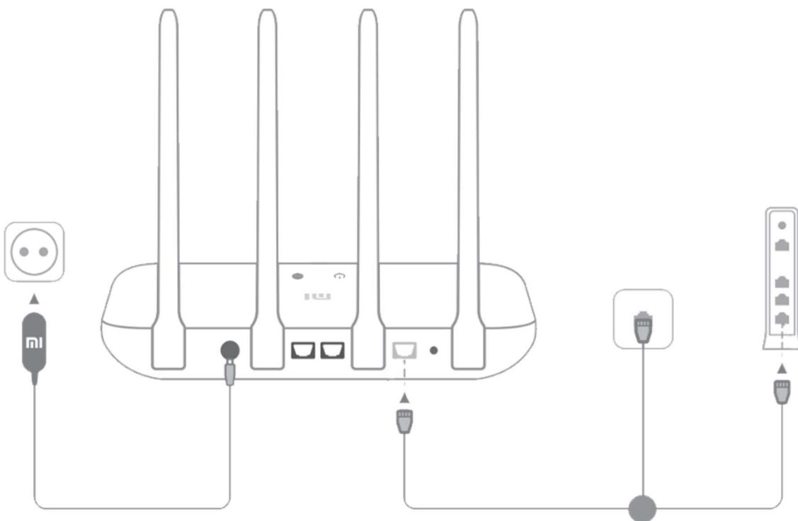
Priklučite router na napajanje, a zatim spojite Internet (WAN) priključak na dsl / kabelski / satelitski modem. Ako je vaša internetska mreža povezana putem ethernet kabela na zidu, spojite ethernet kabel izravno na internetski priključak routeru.
